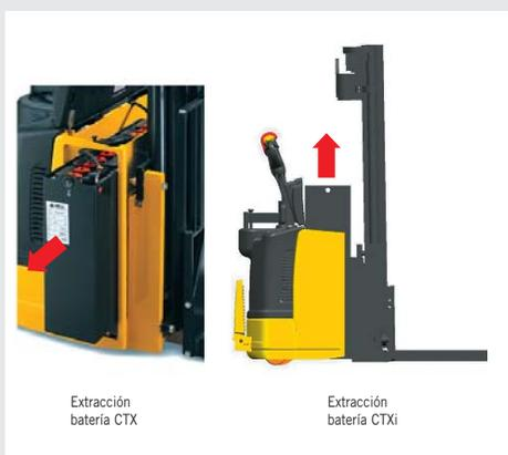
Este apilador OM con mástil y plataforma está diseñado para ofrecer la máxima seguridad y ergonomía. Las tecnologías más fiables garantizan un alto grado de seguridad y productividad en estos apiladores hasta en las condiciones más difíciles de trabajo. La versión CTXi está equipada con la función de elevación inicial. Además los modelos estándar CTX y CTXi poseen timón con dirección asistida.
