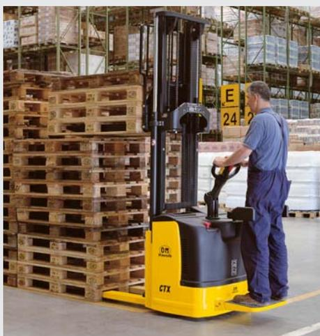
Amplia gama de mástiles: "Simplex", "Duplex" y "Triplex", ofreciendo amplia visibilidad frontal. Las horquillas son subidas y bajadas mediante el pulsador ubicado en el timón, el cual actúa sobre una válvula proporcional.
